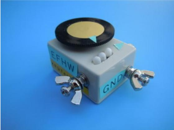
以前、SWRメーターの反射波のみをLED表示する機器と作ったことがある。アンテナを調整する場合、できるだけ送信機とアンテナとの整合をとって、効率的に電波を送り出すためには反射波を少なくすることが行われる。送信機からの出力は個々に決まっているので、損失を少なくアンテナに送り込むことが大事になるからだ。損失が少なくなれば進行波は結果的に多くなるはずなので、アンテナの調整では、あえて進行波を測定しなくてもよいと考えた。以前作ったものは通常のSWR計の回路を用いて、一方の反射波のみを表示するようにしたものだ。
