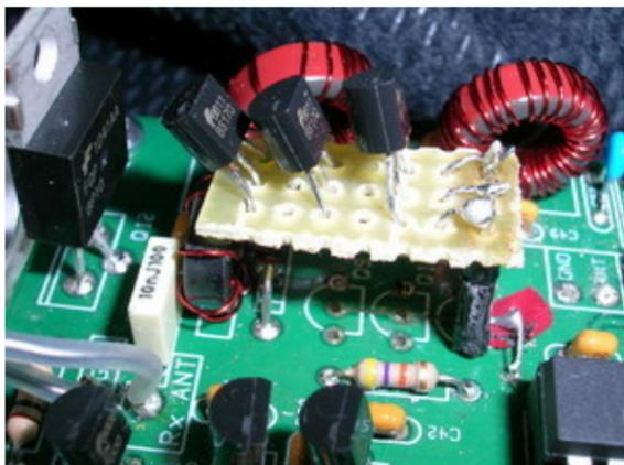
KD1JV Steve Weber がデザインし、Hendricks QRP Kits から発売されている MBDC というキットがある。DDS という発振器で所定の周波数を得て、ダイレクトコンバージョンの受信と QRP の送信ができる装置である。DDS 発振器はマイコンからデータを送り込めば直接その周波数の電波を生成してくれるので、フィルターを換えることで、さまざまな周波数帯 (Multi Band) の機器とすることができる。
