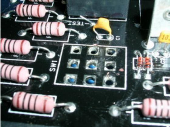
電子機器を製作するとき、ガラスエポキシやベークライトの板の上に薄く銅箔を貼り付け、回路の通りにパターンを形成したものを使っている。部品同士の配線に、この銅箔を使うのである。パターン上の所定の位置に部品を取り付けることにより配線が出来上がるので、いちいち線を引き回す手間がいらなくなる。
