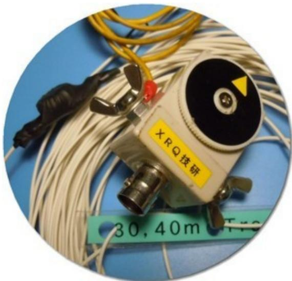
EFHW とは End Fed Half Wave Antenna のことである。訳すとすれば終端給電半波長空中線ということになるだろうか。ダイポールアンテナのように半波長の真真中で給電するのではなく、エレメントの一番端で給電をする。つまり、一番端に給電線を介してトランシーバーを繋ぐのである。
