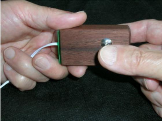
エレキーを操作する時、パドルとかマニピュレーターという機器を使う。機能としては単純な2つのスイッチである。エレキーは短点と長点、およびそれらを区切るスペースを自動的に生成し、符号としてキャラクターを構成すると、キャラクターを区切るスペースも自動生成される装置である。この装置を制御するのが2つのスイッチで、短点側が閉じられると短点が連続して送出され、スイッチが開放されると短点と同じ長さのスペースが挿入される。続けて長点側のスイッチが閉じられていれば短点と長点で構成されたキャラクターになる。2つのスイッチが閉じられていないとスペースになるのだが、連続して符号が送出されると長点の長さ分のスペースを生成しキャラクターの区切りとしている。言葉で書くとわかり辛いのだが、モールス符号を覚えてしまうと感覚的にこれらを判別し、送受信ができるようになる。
